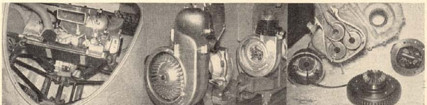
Links ein Blick in den Motorraum des Victoria 250. Tank und Reserverad sind ausgebaut, daher erkennt man auch die Lagerung der hinteren Zweigelenk-Pendelachse. Zwischen Sauggeräuschdämpfer und Vergaser die pneumatische Benzinpumpe (Kurbelkammerunterdruck!), vor dem Kupplungshebel der Solenoid-Schalter. In der Mitte der Motorblock des Victoria 250, man beachte die Zylinderkopfverrippung. Rechts die Solenoidspulen der Schaltung, das Leerlaufsolenoïd befindet sich im topfartigen Gehäuse. Rechts und Mitte Teile des Differentials.
