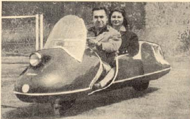
Der Franzose M. Ligier konstruierte diesen „Autoroller“ aus Bauteilen der Lambretta. Die Karosserie besteht aus Leichtmetall, soll aber sehr widerstandsfähig sein. Der Motor ist im Heck untergebracht. Das zweisitzige Fahrzeug erreichte in Montlhéry eine Spitze von 89 km/h. Die Reisegeschwindigkeit soll bei 70 km/h liegen
