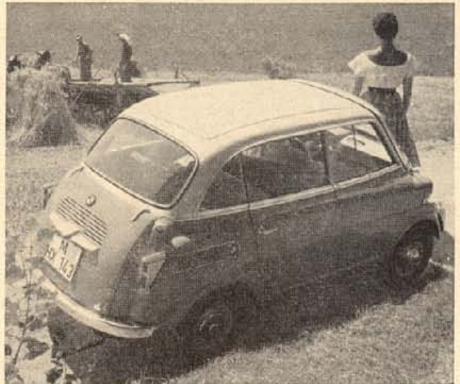
Der neue viersitzige BMW 600 cm von rückwärts gesehen. Er ist mit einem Zweizylinder-Boxermotor ausgestattet, der gebläsegekühlt im Wagenheck liegt. Das Vierganggetriebe ist voll synchronisiert. Das Fahrzeug ist gleichspurig und besitzt ein Differential. Der Einstieg erfolgt durch die Vordertür wie bei der Isetta und zu den hinteren Sitzen durch eine Seitentür rechts. Das Fahrzeug ist außerordentlich geräumig. Platz hinten für 2 Erwachsene und Gepäckablage. Preis 3890.— DM. Heizung mit Aufpreis Foto: O. T. Hoepner
