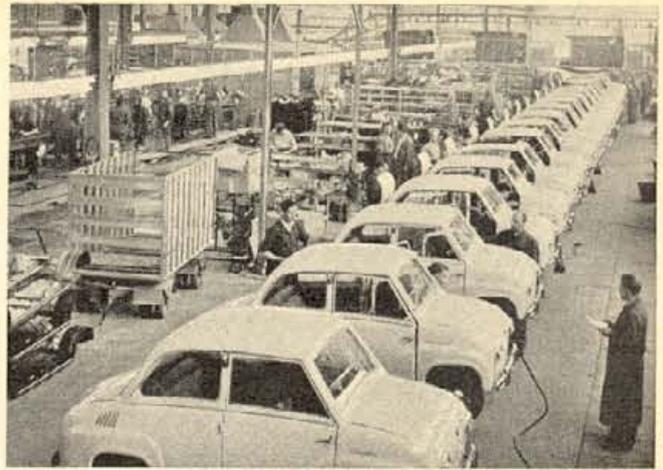
Über 160 Einheiten verlassen täglich das Montageband. Ca. 6 Stunden dauert die Geburt eines Goggomobils
