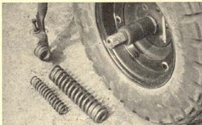
Die ausgebaute Verstärkung der Hinterradfedern beim T/54
