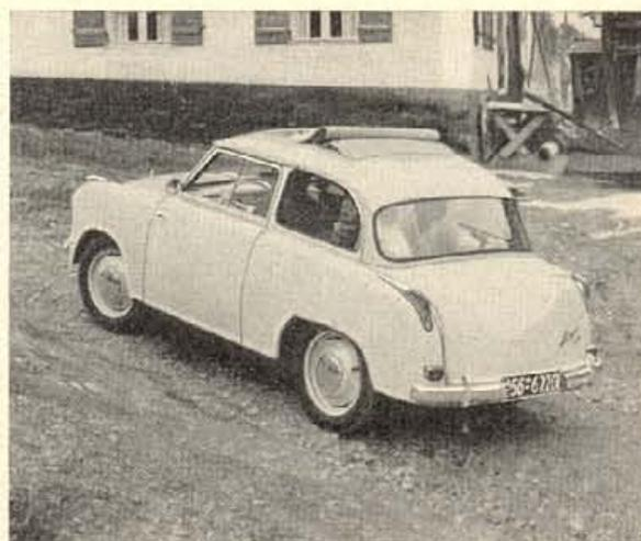
Auf einer Testfahrt Bremen — München, die mit dem LLOYD LP 600 unter Kontrolle des ADAC durchgeführt wurde, betrug die Durchschnittsgeschwindigkeit 71 km/h. Die 834 km lange Strecke schaffte der Wagen bei einem Benzinverbrauch von 5,96 l auf 100 km mit vier Personen und umfangreichem Gepäck in 11 Std. 43 Min. Ein erneuter Beweis für die ausgesprochene Schnelligkeit und Wirtschaftlichkeit des LLOYD 600.
