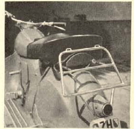
Der Raum unter dem Doppelsattel birgt das Werkzeug und enthält den Reserveschlauch. Der serienmäßige Gepäckträger, der auf dem Hauptrahmenrohr aufsteht, ist Gold wert
