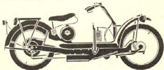
Der englische Near-a-car (beinah' ein Wagen) von 1925 mit Achsenkellenkung, Reibradgetriebe 350-cem-Blackburn-Motor (Siehe RR 1/54, Seite 9)
