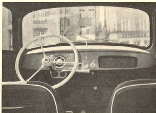
Innenansicht. Großes Steuerrad und übersichtliches Armaturenbrett. Viel Platz für die Füße, auch die des Mitfahrers. Der lange Hebel erleichtert die „Bockwurstschaltung“.
