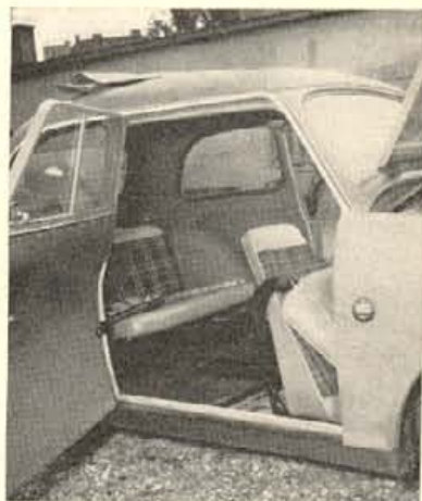
Innenansicht. Der Wagen bietet bequem Platz für 4 Personen, selbst bei langen Fahrten. Das Ein- und Aussteigen ist durch den doppelt abklappbaren Sitz sehr erleichtert
