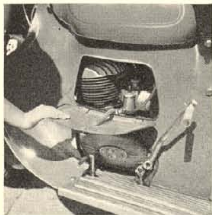
Die seitlichen Klappen sind so groß bemessen, daß man ohne Schwierigkeiten zu Kerze und Vergaser heran kann. Die Feder an der Klappe ist eine Sonderausführung, die sich bewährt hat, da man auf dieser Seite öfter zu dem Benzinhahn muß. Heute sind die Klappen noch größer, und der Schalthebel läuft nicht mehr unter dem Trittbrett durch.
