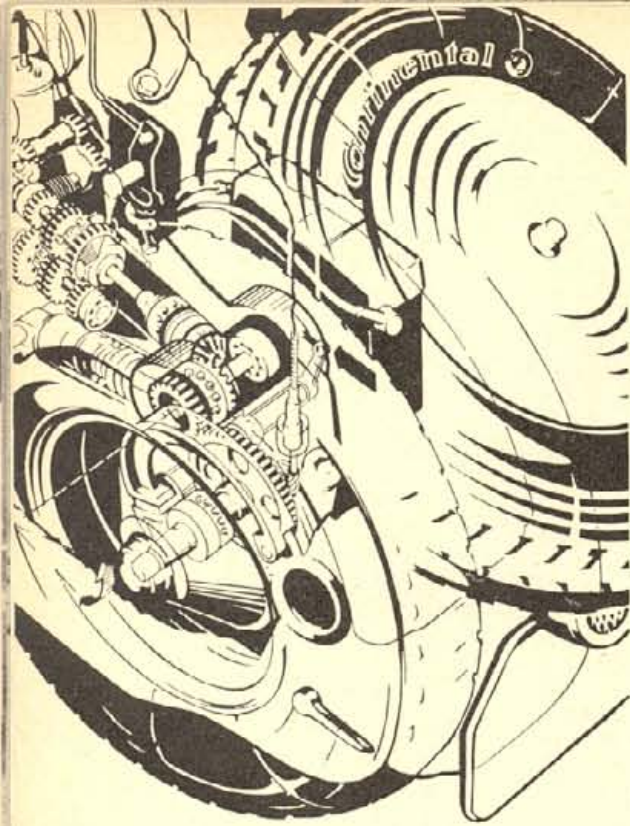
Hinterer Innenbackenbremse bei der NSU-Lambretta. Nebenbei gut zu sehen ist auch die Kardanübertragung.
