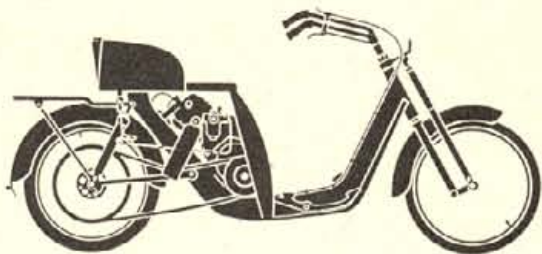
Im Jahre 1921 baute DKW das Lomos-Sesselrad, analog unserem Roller schon mit Hinterradschwinge und Federheinen
