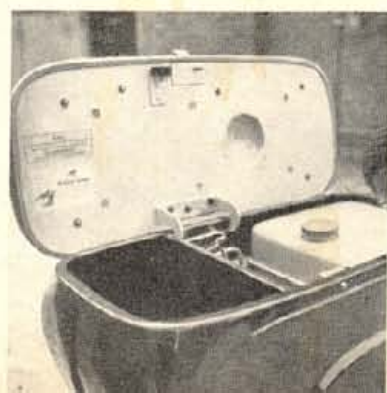
Der abschließbare, staub- und regendichte „Gepäckraum“ unter der Sitzbank des Heinkel „Tourist“ sucht seinesgleichen und ist äußerst praktisch. Man kann außer der Schutzbrille, Rollerkrappe, den Handschuhen, einem Fotoapparat (ich nahm dazu meine Rolloflex) und dem Rollermantel (Marquardt) sogar noch eine Luftmatratze darin unterbringen
