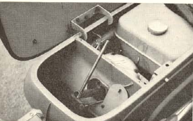
Sitzpolster hochklappen — kleine Klappe auf — Kerzenschlüssel rein — alles kinderleicht
