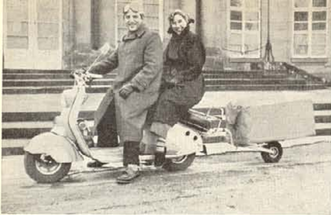
Der Campo-Anhänger, „Filius“ für Motorroller. Es läßt sich darin sehr viel Gepäck unterbringen. Außerdem gibt es kein Garagenproblem, denn der Campo ist schnell zusammengelegt und in der Wohnung untergebracht. Der Filius-Einspuranhänger ist 90 cm lang, 45 cm breit und die Höhe des Laderaums beträgt ebenfalls 45 cm.
