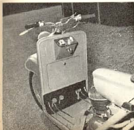
Die Armaturen vom Strolch. Links die beiden Schallhebel, rechts die Bremse
