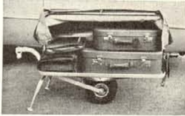
Der Campo-Anhänger, „Filius“ für Motorroller. Es läßt sich darin sehr viel Gepäck unterbringen. Außerdem gibt es kein Garagenproblem, denn der Campo ist schnell zusammengelegt und in der Wohnung untergebracht. Der Filius-Einspuranhänger ist 90 cm lang, 45 cm breit und die Höhe des Laderaums beträgt ebenfalls 45 cm.
