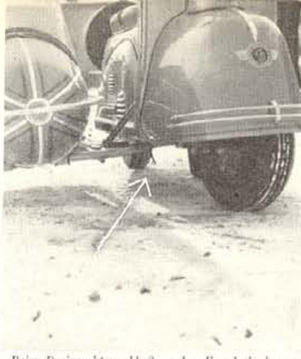
Beim Dreipunktanschluß werden Kugelgelenke verwendet. Der Hebel zum Öffnen und Schließen (Pfeil) ist deutlich zu erkennen
