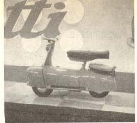
Das ist der PIATTI-Roller, der auf dem Brüsseler Salon zu sehen war. 125 ccm, 75 km/h Spitze, Gewicht 70 kg, selbsttragende Karosserie. Etwas eigenwillig die Anordnung der Sitzmöglichkeiten. Fachleute sind von den Fahrignachrichten begeistert.
