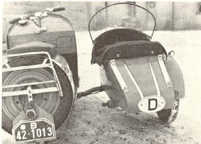
Hier handelt es sich um einen Brückenanschluß zwischen Maico-Mobil und Steib-Seitenwagen, eine sehr solide Ausführung
