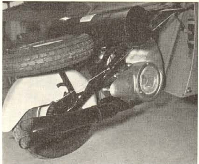
Der Motor von der Gehäuseseite her gesehen. Deutlich zu erkennen der großdimensionierte Schalldämpfer und die freiliegende Kette.
