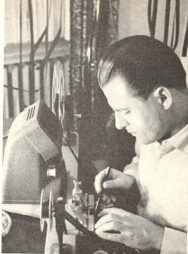
Sommerfreuden auf der Leine. Der Film wurde in alle seine Kameraeinstellungen zerlegt, nummeriert und auf eine Wäscheleine gehängt. Von dort wird nun Meter für Meter abgenommen, um ihn dem bereits fertig geschnittenen und geklebten Streifen anzufügen
